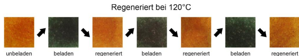
Abbildung 2: Farbänderung durch Adsorption und Regeneration.
